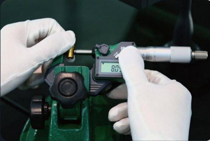
Mikrometre entegreli kablosuz verici
