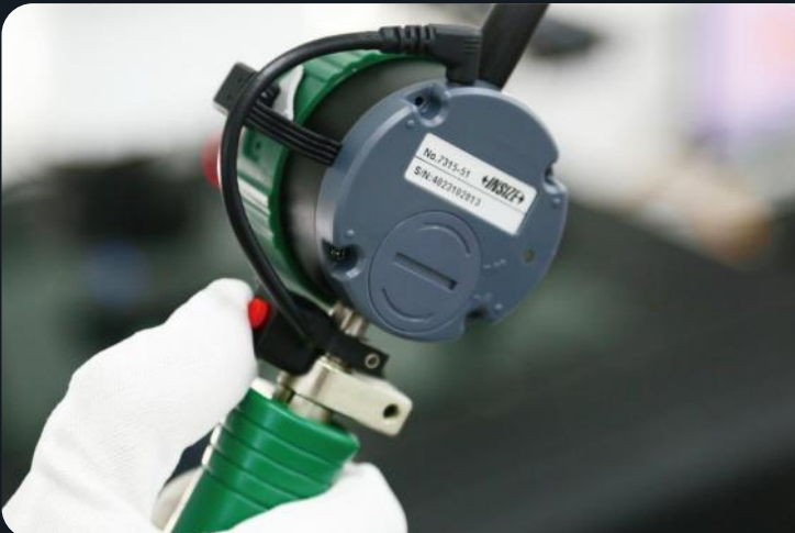
Dijital komparatör /Digital ölçüm komparatörleri /Dijital silindir komparatörleri entegreli kablosuz verici
