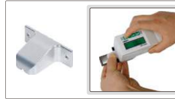
prob kapağı (dahil); küçük iş parçaları doğrudan ölçüm probuna koyabilir
