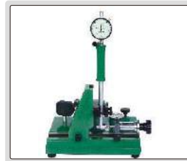
silindir komparatörün doğruluğunu kontrol etme (aralık 6-450mm)
