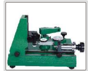
deneme komparatörün doğruluğunu kontrol etme
