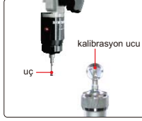
prob (opsiyonel), Ø2mm ve Ø3mm uç, Ø25mm kalibrasyon ucu içerir ve ölçme doğruluğu 10µm'dir
